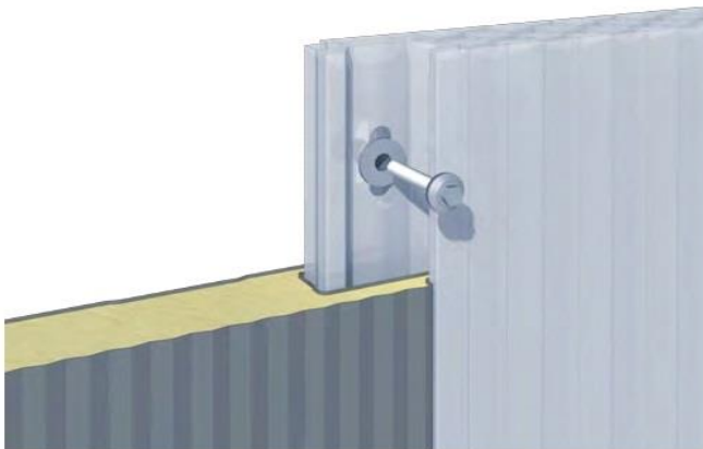
DETALLE ENTREGA ENTRE PLACAS DE POLICARBONATO - PANEL METÁLICO
