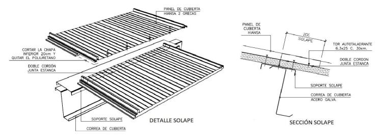
Para resolver el solape entre los tapajuntas del panel, se procederá tal y como indican las figuras siguientes, teniendo en cuenta de no realizar nunca el solape de panel en el mismo punto que el el solape del tapajuntas.
