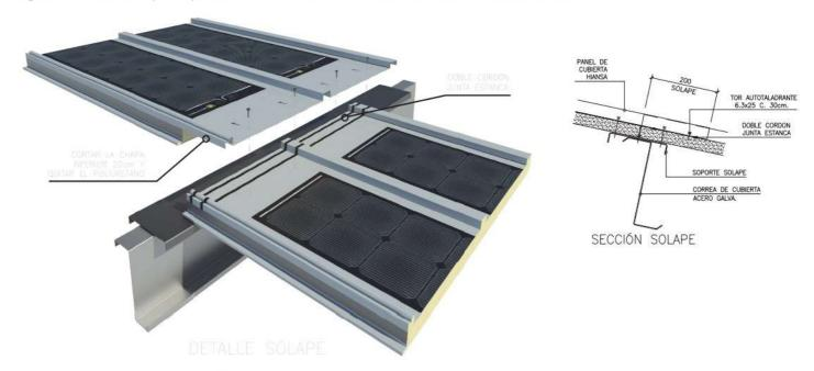
Para resolver el solape entre los tapajuntas del panel, se procederá tal y como indican las figuras siguientes, teniendo en cuenta de no realizar nunca el solape de panel en el mismo punto que el solape del tapajuntas.
