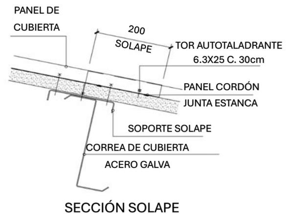
Para resolver el solape entre los tapajuntas del panel, se procederá tal y como indican las figuras siguientes, teniendo en cuenta de no realizar nunca el solape de panel en el mismo punto que el solape del tapajuntas.
