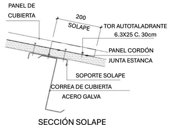
DETALLE PANEL 5 GR SIN TAPAJUNTA VÁLIDO PARA CUALQUIER TIPO DE PANEL DE CUBIERTA SIN TAPAJUNTA
