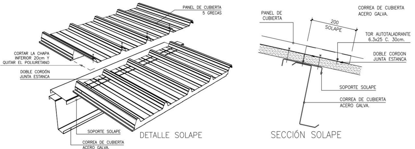
DETALLE PANEL 5 GR ST. VÁLIDO PARA CUALQUIER TIPO DE NUESTRO PANEL DE CUBIERTA
