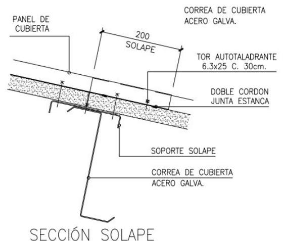
DETALLE PANEL 5 GR ST. VÁLIDO PARA CUALQUIER TIPO DE NUESTRO PANEL DE CUBIERTA
