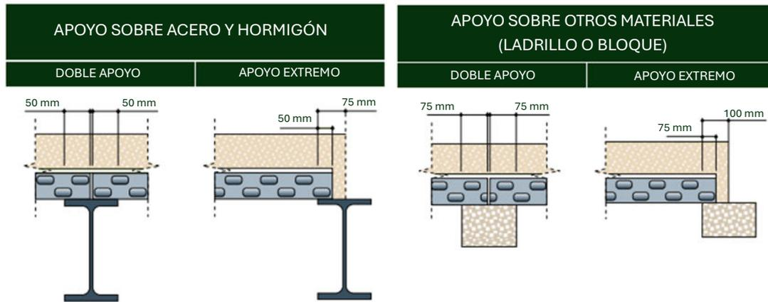
La unión del forjado a la estructura será por tornillo, clavo o soldadura, en función de la decisión del proyectista y siempre respetando las medidas mínimas indicadas para cada caso en las figuras adjuntas. Se recomienda la fijación de cada chapa a medida que se van montando y comprobar al final que todas estén fijadas.
